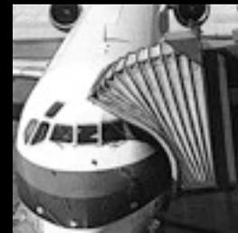
Les plis permettent dans le cas ci-contre l'adaptation parfaite de la passerelle à la forme courbe de l'avion, afin d'éviter tout interstice dangereux.
